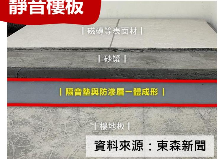
e.g.採濕式施工法將隔音墊永久嵌入樓板結構，同時灌漿打底，其因操作流程複雜，工序時間長，人工成本高，相對增加建築成本。
